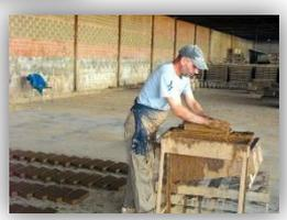
Figura 4. Moldeo y secado
