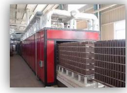
Figura 7. Horno túnel
