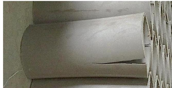
Figura 18. Fisuras en las tejas durante el proceso de secado
